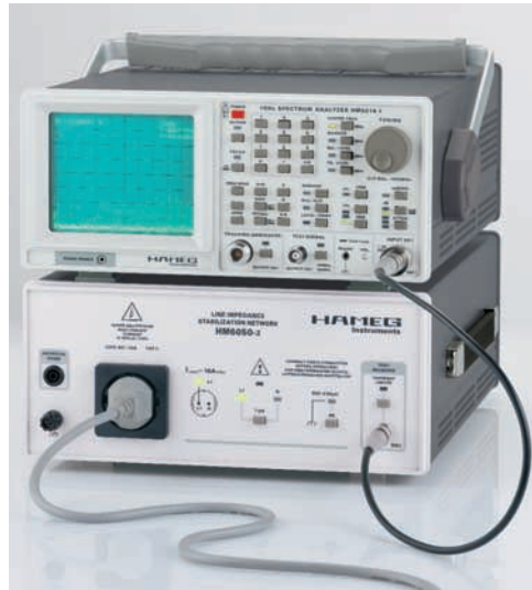
Mesure de perturbations liées aux câbles au moyen d'un analyseur de spectre et d'un réseau fictif
