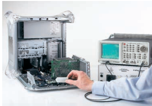
Recherche d'une énergie parasite rayonnante à l'aide de la sonde de champ magnétique (sonde champ H) et de l'analyseur de spectre
